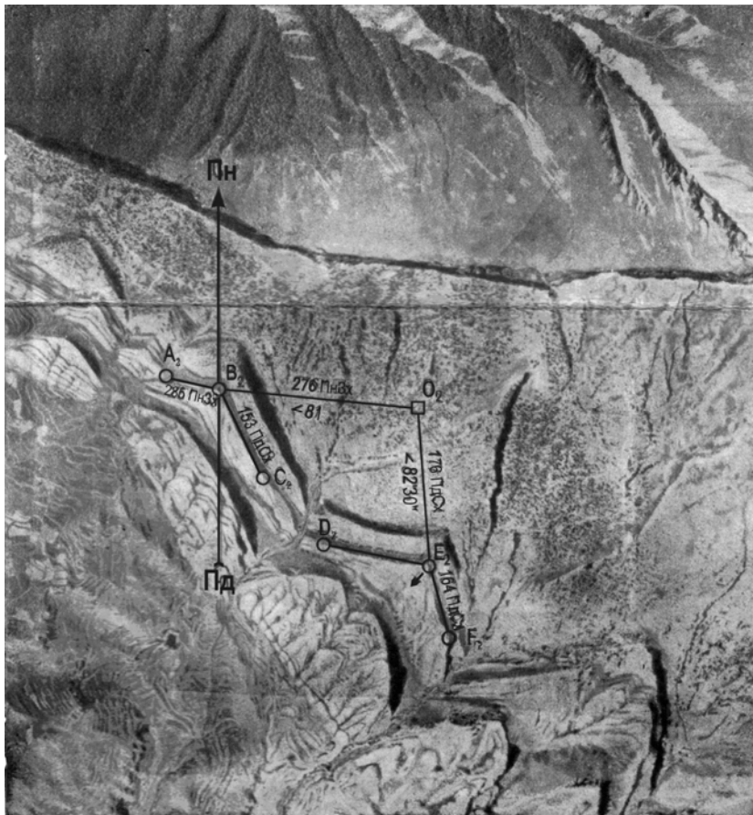
Рисунок 16.4. Лівий (а) і правий (б) АФЗ: А, В, С – точки на виході пласта; О – головна точка аерофотознімку
